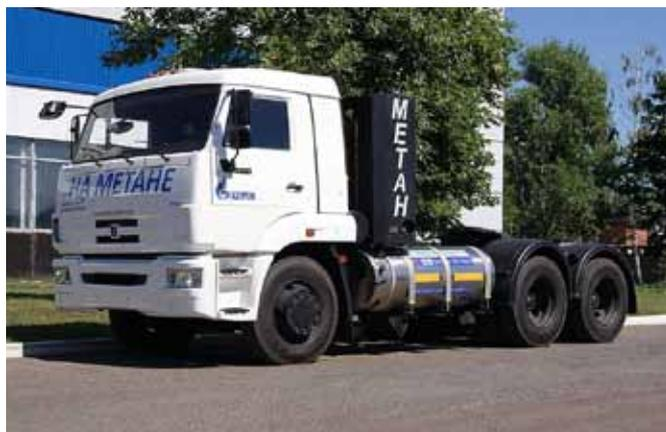
«реальной жизни» для грузовых автомобилей и автобусов с газовыми CNG-двигателями часто используют традиционные высокощелочные моторные масла типа ACEA E7, API CH-4, CI-4. Вот здесь и начинаются проблемы. Почти все потребители отмечают прогорание клапанов, перегрев двигателя, белый налет в камере сгорания, деформацию седла и тарелки клапана. И все это связано, прежде всего, с неправильным подбором моторного масла.
